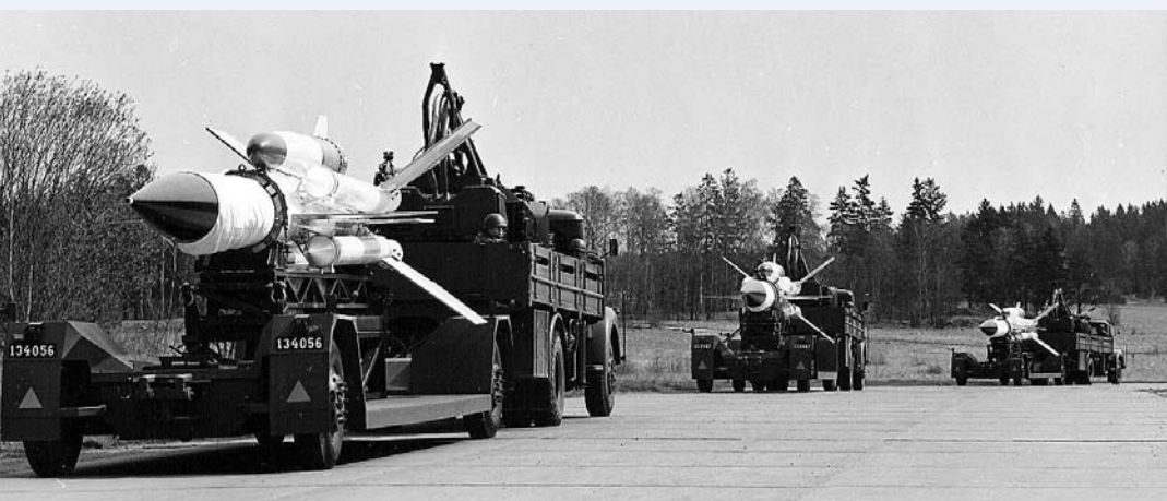
Tre robotlastbilar 809 med robotsläp. Bilarna lastade med lavetter och släpen med robotar.
