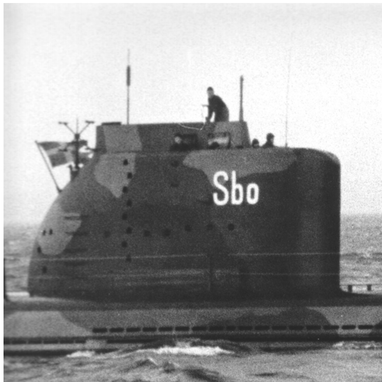
På tornets akterkant, hitom flaggan, syns antennen till PS-37 luftspaningsradar
