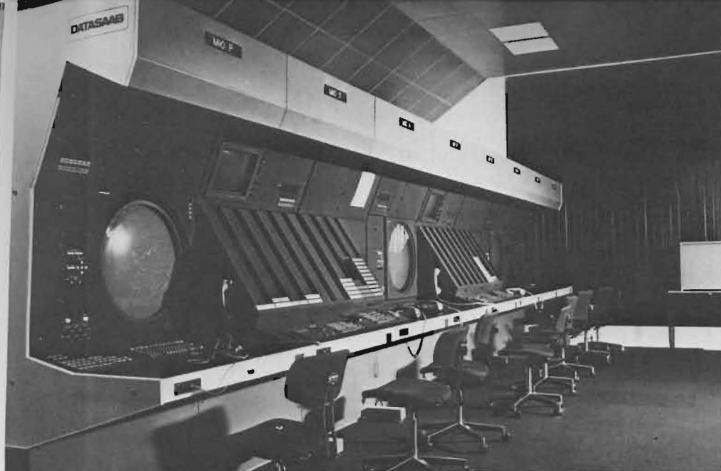
● Flygtrafikledningscentralen som den ter sig i Mineral'nyje Vodny, Sovjetunionen. De sexton arbetsplatserna är försedda med indicatorsystem för såväl radardata som färdplaner.
