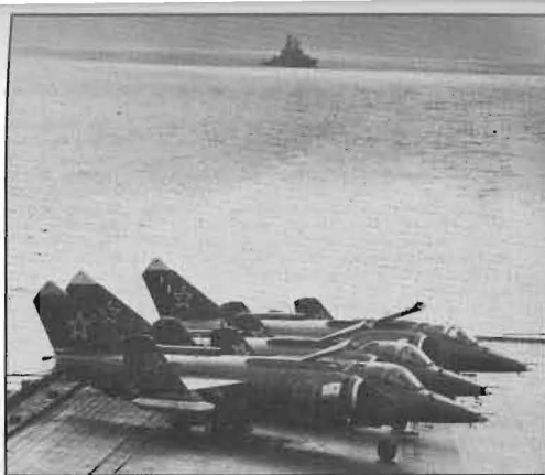
Hangarfartyget "Kiev" är, förutom hkp och rb, utrustat med flyg: Jak-36 "Forger" A+B. På sistone har "Forger" modifierats ovanför vardera sidoluftintag; två långsgående metallstråk kringgärdar upptill luftintaget till den kroppscentralt placerade lyftmotorn.
