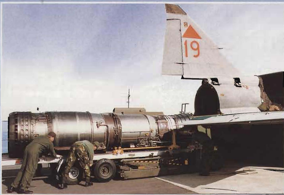
Motormontering på krigsbas med "miljöskydd" över flygplanskroppen.
