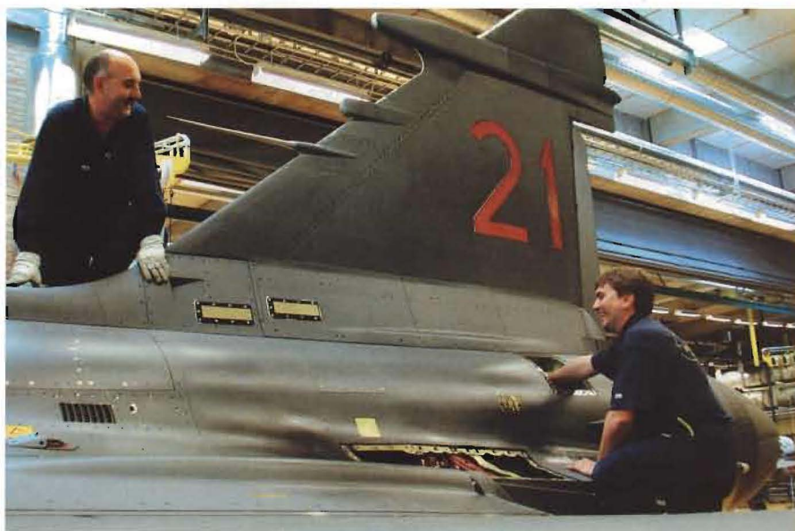
De s k pri-flygplanen har genomgått 800-timmarstillsyner vid Försvarmaktens flygverkstäder i Säténäs. På bilden ses Anders Engel och Ola Nilsson arbeta med flygplan 39121. Foto: Håkan Brandt
