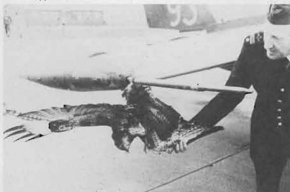
En rovfågel gick sitt öde till mötes vid konfrontation med en SK 60:s pilotör. En relativt enkel skada. – Vårre är det då frontrutan eller motorinloppen träffas.
