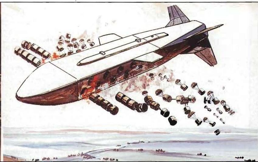
Redan fr o m JAS 39:s förbandsintroduktion kommer denna bombkapsel med yttäckande substridsdelar att kunna hängas på Gripen. Har flygutprovats m m på AJ 37.
