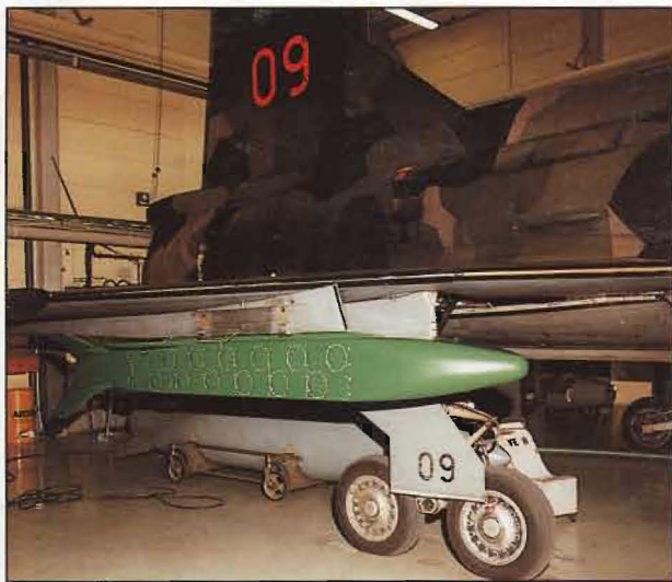
Redan fr o m JAS 39:s förbandsintroduktion kommer denna bombkapsel med yttäckande substridsdelar att kunna hängas på Gripen. Har flygutprovats m m på AJ 37.
