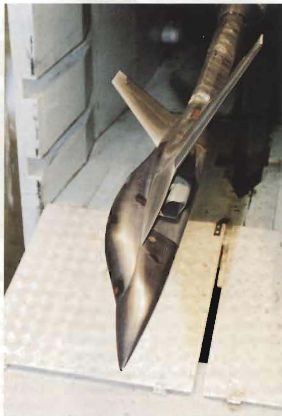
Vindtunnelmodellen av ett framtida skolflygplan testas vid FOI i Bromma.
