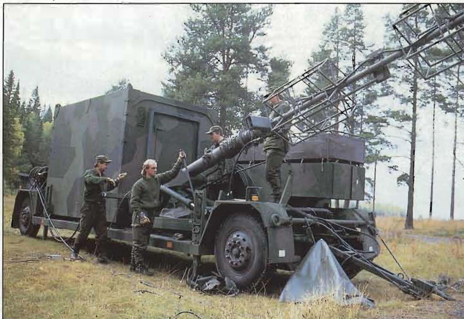
Transportabel markradiostation under upprättande.
