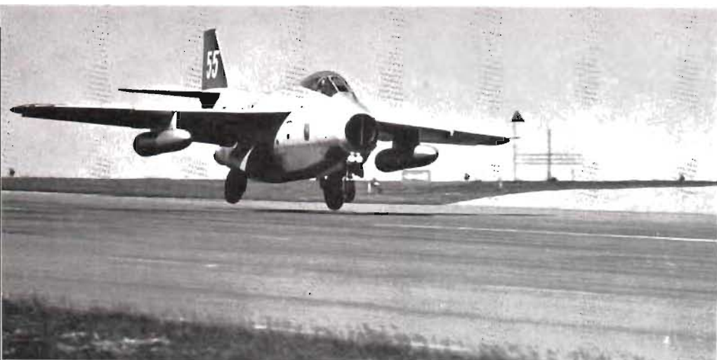
S 29 C — utrustad med fölltankar med inbyggda målyteförstärkare, som bättre reflekterar radarvågorna.
